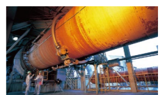
アジア最大規模の粒状活性炭賦活炉(ミナベ化工)
